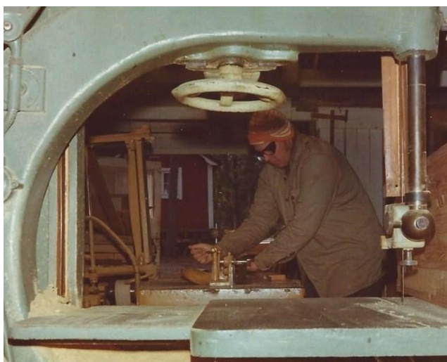
Bandsågen, stor nog att klyva 300 mm.
