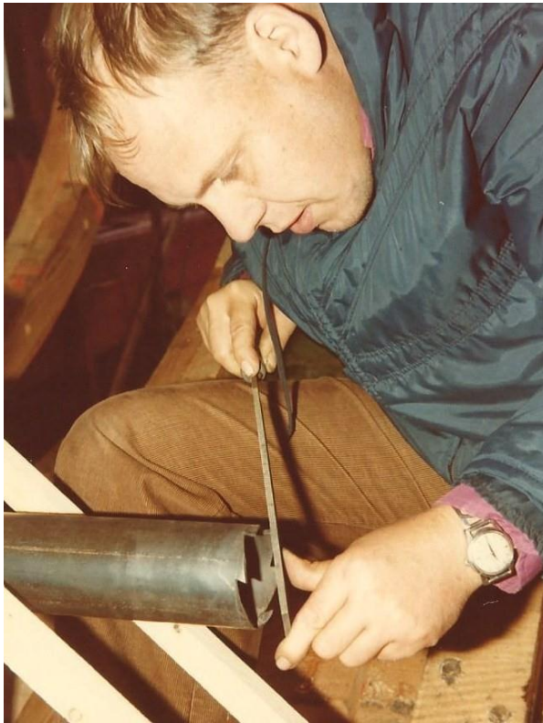
Ett stålrör filas till en borr, som riktas, varmed hålet i akterstaven borras för prop.-hylsan.
