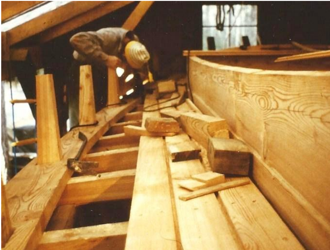
Skarndäck och brädgångsstöttor av lärk och däck av kvartersågad kärnfuru.
